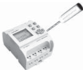
Fig.2.2 – Rimuovere il pannello LCD come da istruzioni
