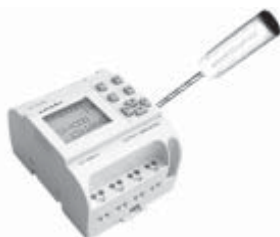
Fig.2.2 – Rimuovere il pannello LCD come da istruzioni
